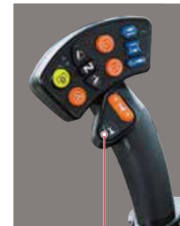
枕地制御スイッチ
