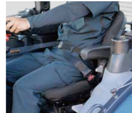
エアサスペンション付シート シートスイッチ付(離席時PTO自動停止)
