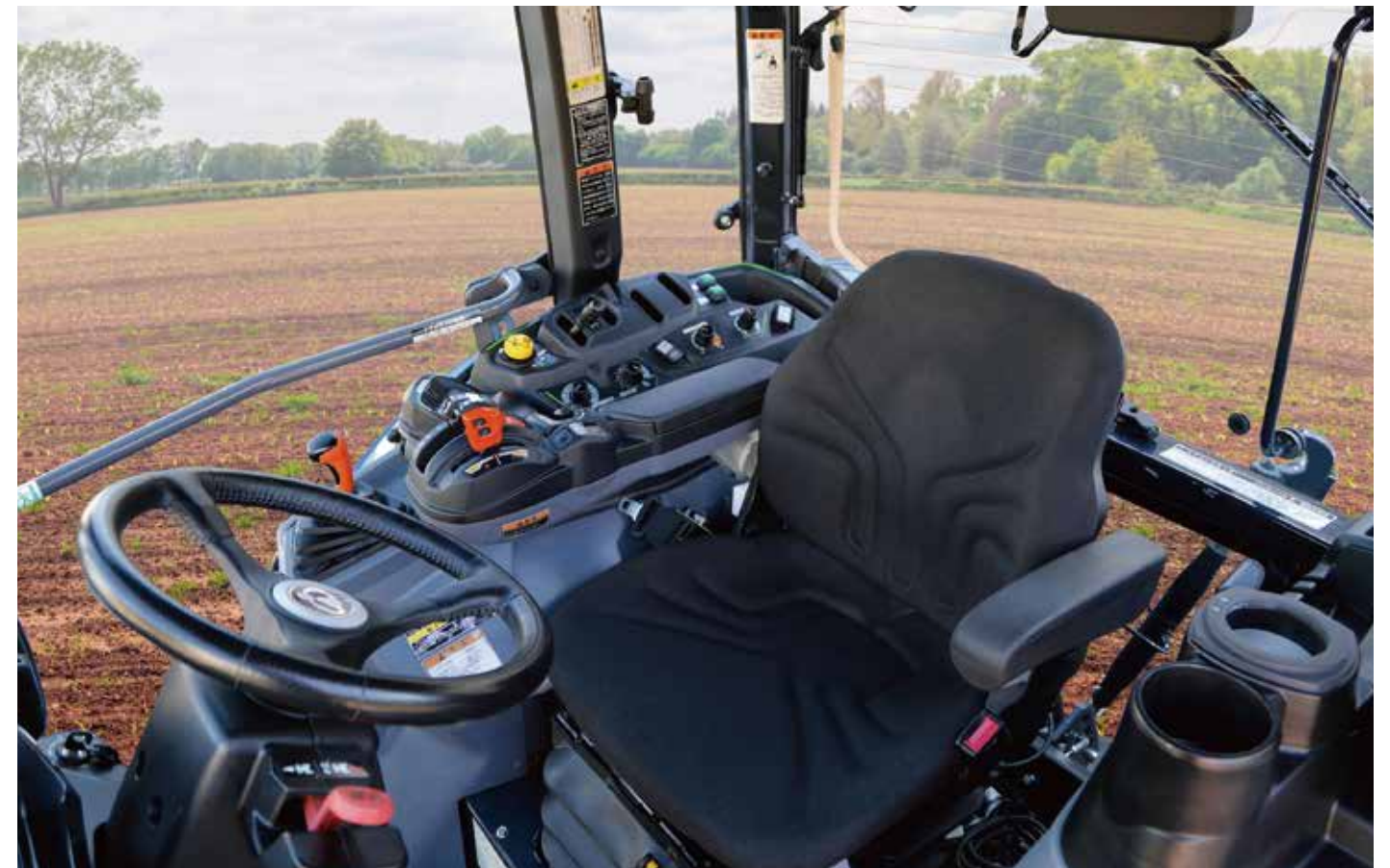
エアサスペンション付シート シートスイッチ付(離席時PTO自動停止)
