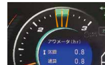
エンジン回転数を作業回転域(グリーンゾーン)でコントロールします。
