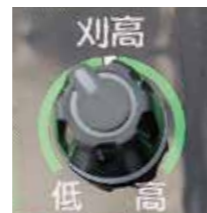
刈取部がダイヤルで設定した高さまで下降します。
