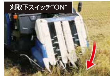
刈取部がダイヤルで設定した高さまで下降します。
