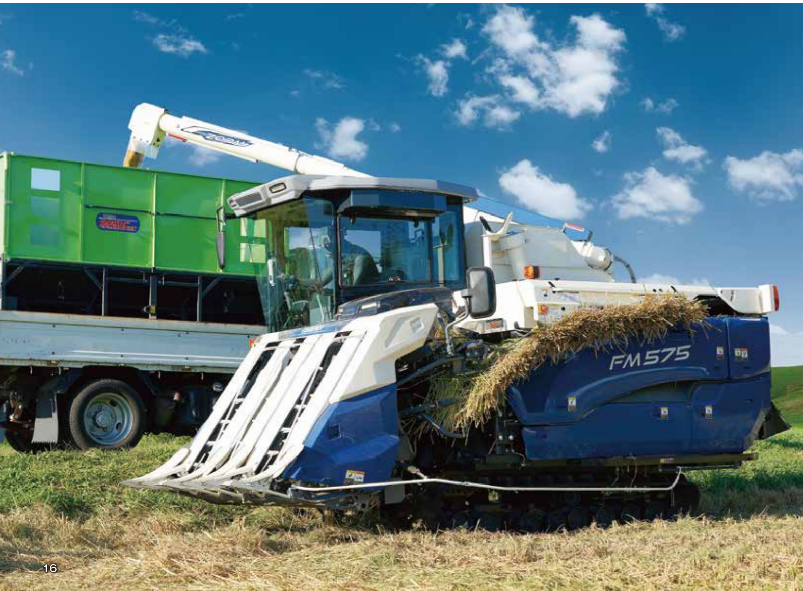
収納時はオーガ先端が上を向き糶こぼれを防止します。
