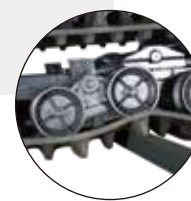
イコライザが可動することで、ほ場の凹凸による機体姿勢変化を抑えます。
