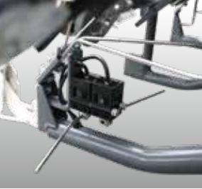
自動方向制御装置
