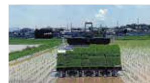
往復植えが終わりに近付くと、あぜクラッチを制御して、内周植え8条となるよう自動調整します。
