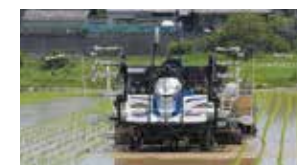
往復植えが終わりに近付くと、あぜクラッチを制御して、内周植え8条となるよう自動調整します。
