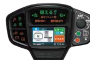
● 田植機カラー液晶マルチモニタ画面
