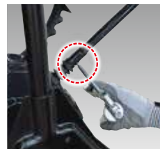
ロータ伝動軸シャフト部
