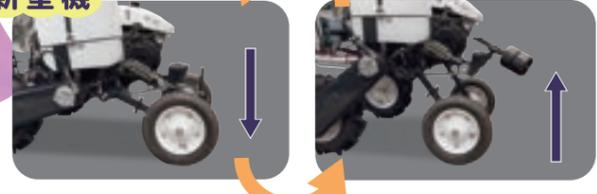
現行機はほ場ごとに前輪高さ調節を行い適正な植付姿勢にセッティングしていましたが、新型かんしょ移植機は前後輪が同時に上下しうねの高さが変わっても自動で適正セッティングにすることができます。
