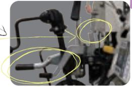
植付部を持ち上げて固定することのできるレバーを標準装備しました。旋回する際、隣のうねに接地輪が当たりうねを崩すことを防ぎます。もう一つのレバーと一緒に握るだけで簡単に解除することができます。
