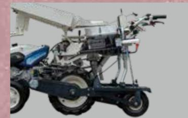
フロア下部の車輪は後輪タイヤに連動して駆動します。これにより四輪駆動になることで高い走破性を得ることができます。
