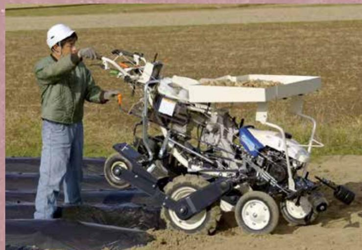
旋回時乗用フロアは自動でリフトしますので、歩行型のじゃがいも植付機と同じ操作で旋回することが可能です。
