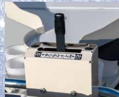
ハンドル側のサイドクラッチレバーに加え、乗車席から手の届きやすいところにサイドクラッチレバーを装備しました。このレバーを押し引きすることにより1レバー操作で座ったまま機体進行方向の微調整が可能になります。
