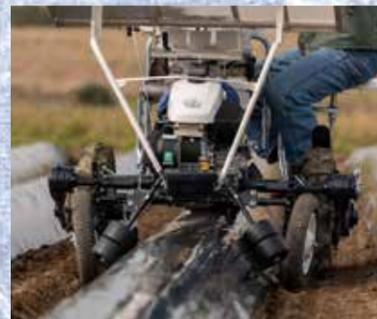
マルチうねへの機体追従性を高めるために、うねガイドローラを標準装備しました。旋回時は自動で上昇しますのでうねを傷めません。
