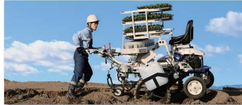
機体バランスが良く旋回しやすい安心設計。前輪を押し下げるのではなく、機体が前進している状態からハンドルを持ちその場にとどまるようにすることで前輪が簡単に浮き上がります。
