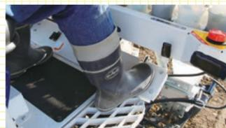
足で踏むだけで作業を一時停止できます。主クラッチレバーを操作することなく一時停止ができますので作業効率が上がります（ペダルを踏んでいる間のみ、一時停止します）。
