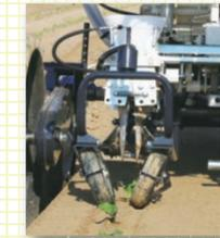
ホッパーが横開きなため植付穴も横長に開くが、鎮圧輪により横から植付穴を押しやるため土の戻りが良く苗がきれいに植わります。
