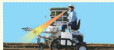
機械の進行方向に対して後ろ向きに座って作業するので、植え付けた苗を顔を上げるだけで確認することができます。
