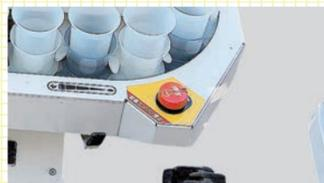
押すだけでエンジンが停止するスイッチを、乗車席側にも搭載しました。もしもの際でも安心です。
