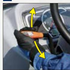
前後進の切り替えを手元のレバー1本で行えます。シンクロメッシュを採用しましたので、かるい力で操作できます。HST仕様(G型)はノークラッチで前後進が切り替え可能です。
