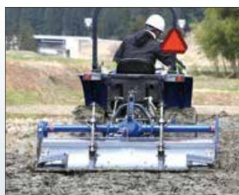
セミクローラや湿田用補助車輪など、広幅の車輪で作業を行っても跡が残りにくいロータリです。
