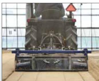
チェーンケースが中央に配置されています。深く耕せますので、畑作に威力を発揮します。
