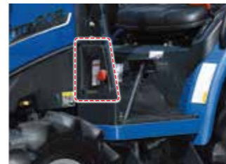
マッドカバー 足元左右に取り付けておりますので、走行時の泥よごれを防止できます。
