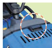
フードロックを引くだけで軽い力で、簡単にボンネットを開けることができます。
