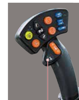
枕地制御スイッチ
