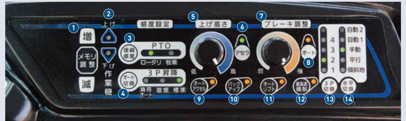
**電子油圧操作ボックス** 操作席右側に電子油圧操作ボックスを配置しました。各種機能の設定が簡単に行えます。
