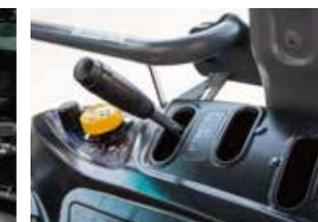
\*写真はG型 外部油圧コントロールレバー \*写真はZ型
