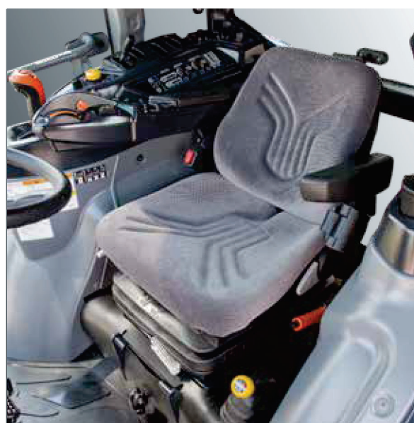
■ グラマー社製サスペンションシート 疲労を軽減するサスペンションシートを採用。
