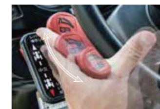
デクラッチ機能付き フィンガータッチリニアシフトレバー
