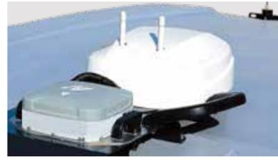
4G回線に対応した遠隔操作装置タブレット(パイロットアイ+W)の情報を送受信するアンテナです。
