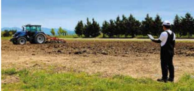
専用タブレット上のアプリ(パイロットアイ+W)でカメラ画像での監視補助、センサの検出状況確認、自動走行の入り切りやトラクタの設定変更ができます。\*2 \*3 \*4
