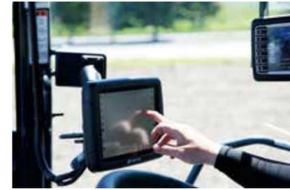
トプコン社製X25ガイダンスを用いて作業登録、旋回パターン、経路設定等を行えます。(ロボット専用モデル)
