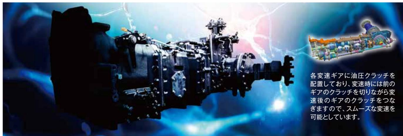
各変速ギアに油圧クラッチを配置しており、変速時には前のギアのクラッチを切りながら変速後のギアのクラッチをつなぎますので、スムーズな変速を可能としています。
