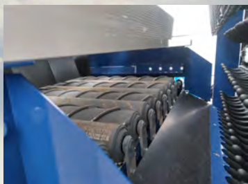
大径スパイラル カッティング部
