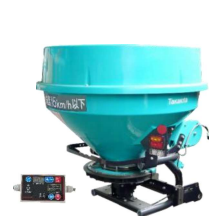
BC3501D ホッパ容量350ℓ 電動開閉シャッタ
