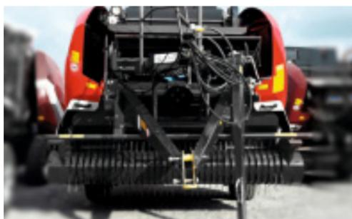
2.40mカムレスピックアップは、刈り草の幅が広い場合に適します。市場のロールベアラーの中で最大の作業幅を持ちます。
