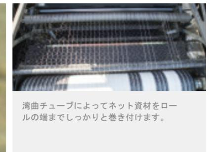
湾曲チューブによってネット資材をロールの端までしっかりと巻き付けます。
