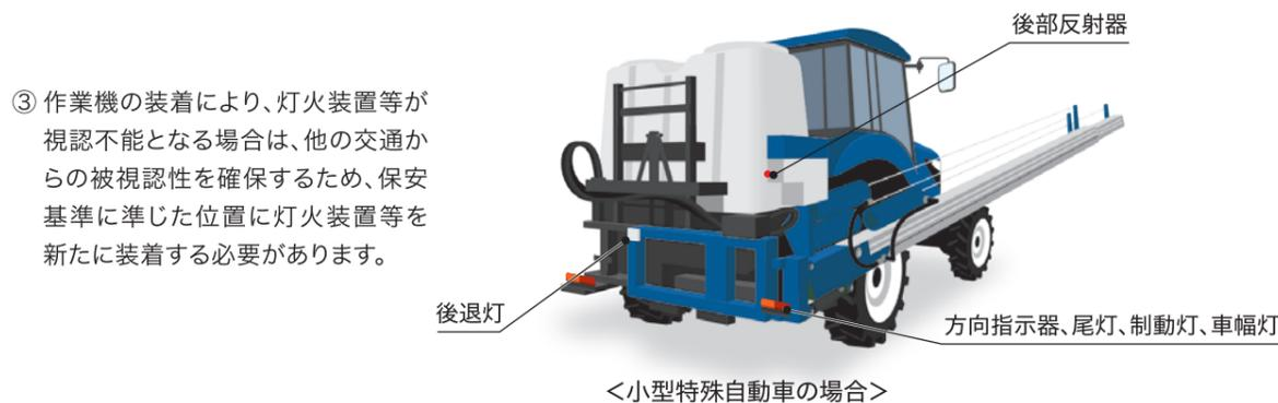
③ 作業機の装着により、灯火装置が視認不能となる場合は、他の交通からの被視認性を確保するため、保安基準に準じた位置に灯火装置等を新たに装着する必要があります。
