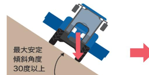
※車両総重量が車両重量の1.2倍以上又は、積載により重心高さが上がるものは最大安定傾斜角度35度以上
