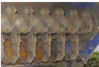
また、刈刃軸が約1,900rpmの高速回転ですので、刈畝がきれいで、しかも速い速度で刈取ができスピーディに作業が完了します。
