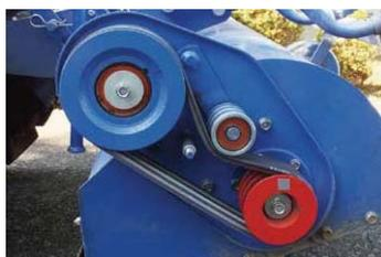
また、駆動ベルトは3本使用、確実に動力を伝達します。なお、ベルトが伸びた場合は、オートテンションローラー方式ですので、最適な張力が得られ、ベルトのスリップがありません。
