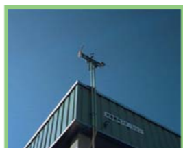
気象観測ステーションと室内環境センサーの情報に基づいた全自動総合環境制御設備
