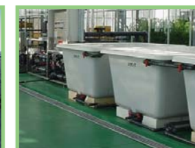
コンピュータ管理の養液混合供給設備
